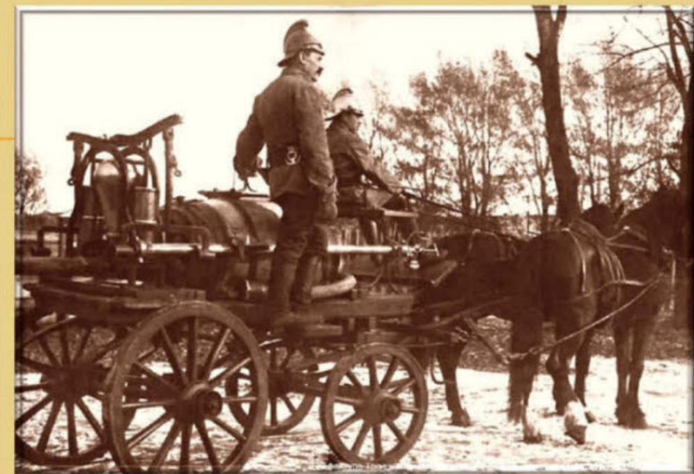
Пожарный параконный бочечно-насосный, ранее трубо-бочечный, ход, насос 1, вода 420 л, рукавных катушек 1, керосиновых факелов 2, боевой расчёт 2, сухой вес 800 кг.
